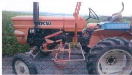
Fig. 2a & b. Utstyr brukt ved falsk såbedd. Øverst ugrasharv og under 'minislodd' der består av en wire spendt ut på trollramme midtstilt under traktor.
